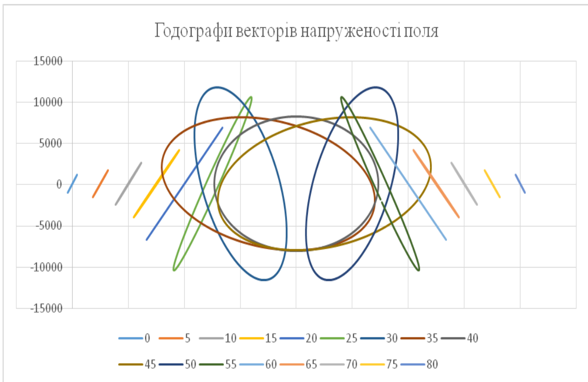
Рисунок 3 – Годографи векторів напруженості електричного поля ПЛ 500 кВ (у відносних одиницях) для різних значень відстаней від початку санітарно-захисної зони
