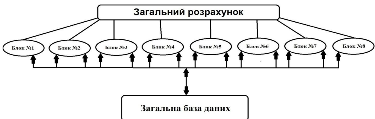
Рисунок 1 – Ієрархічна структура системи автоматизованого проектування колекторних двигунів постійного струму з сирієсним збудженням малої потужності
