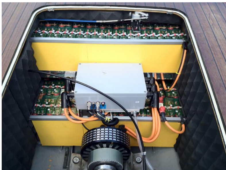
Рисунок 6 – Аксіальний електродвигун Emrax 228 встановлений на яхту
