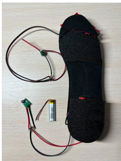
Рисунок 3 – Експеримент з зарядкою акумулятора з використанням розробленої устілки (а) та батарейки (б)
