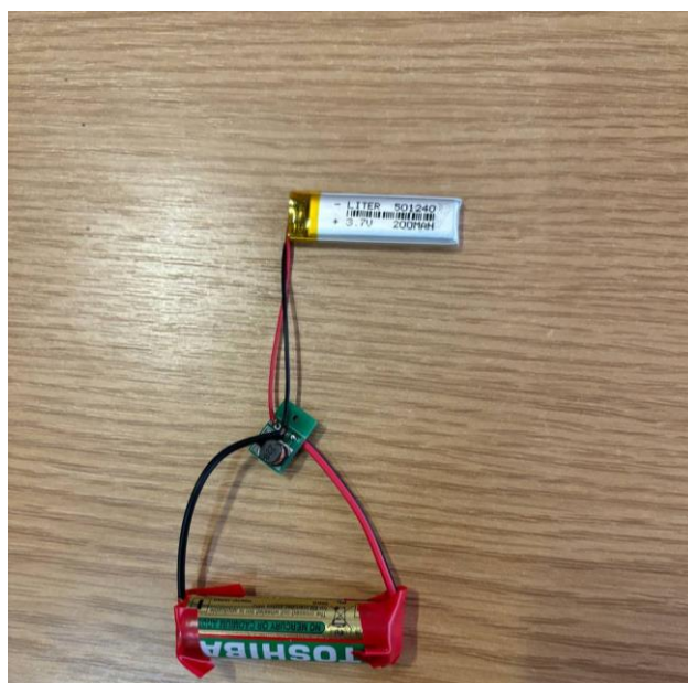
Рисунок 3 – Експеримент з зарядкою акумулятора з використанням розробленої устілки (а) та батарейки (б)
