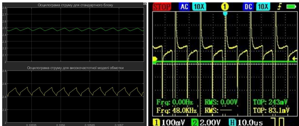
Рисунок 4 – Осцилограми струму при живленні обмотки імпульсами напруги частотою 48 кГц
