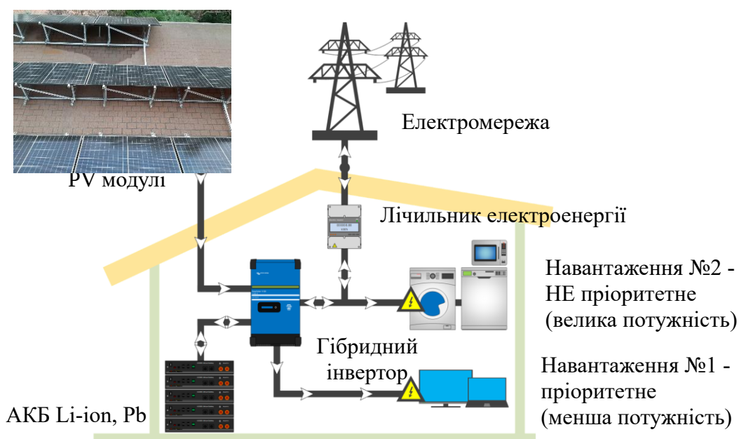
Рисунок 3 – Пояснювальна схема сонячної електростанції нашого будинку потужністю 10 кВт
