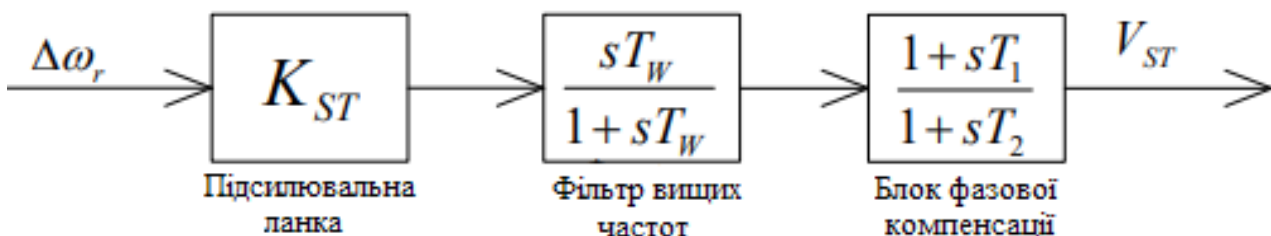
Рисунок 2 – Структурна схема Speed-based PSS
