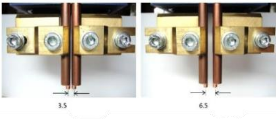
Рисунок 6 – Вигляд електродів із відстанню між ними у 3.5 мм та 6,5 мм
