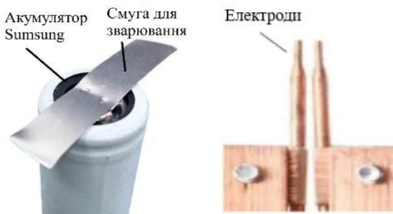
Рисунок 2 – Компоненти, що задіяні при формуванні точки зварювання
