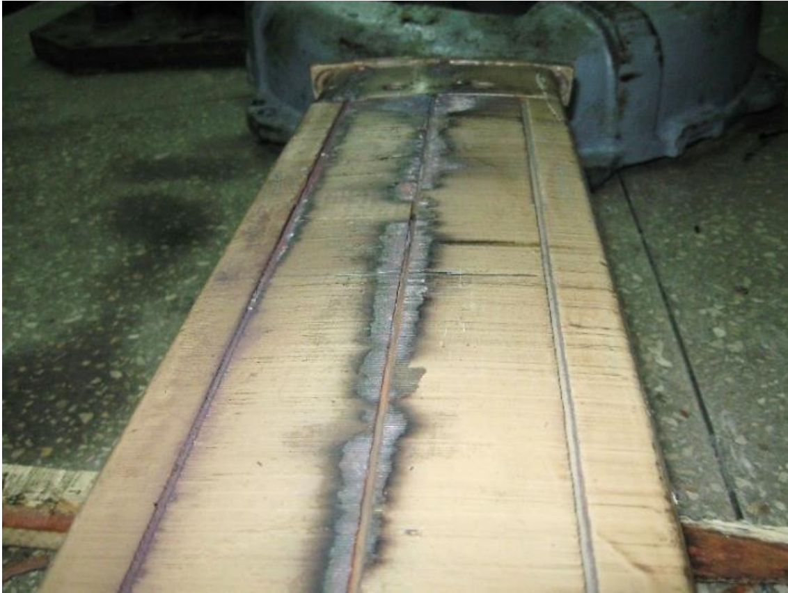
Рисунок 1 – Перегрів листів електротехнічної сталі полюсного наконечника капсульного гідрогенератора потужністю 23 МВА внаслідок перегріву стержня демпферної обмотки
