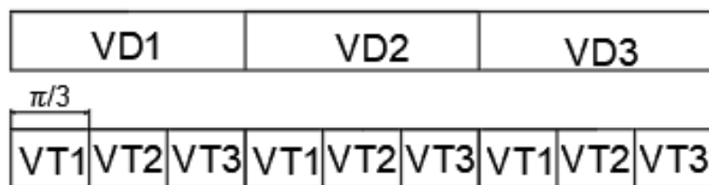
Рисунок 3 – Алгоритм комутації діодів і транзисторів у режимі 1
