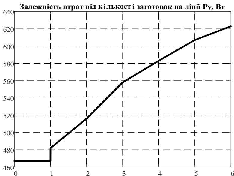
Рисунок 4 – Залежність втрат активної потужності від кількості деталей на конвеєрі
