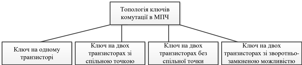
Рисунок 1 – Блок-схема топології ключів комутації в МПЧ
