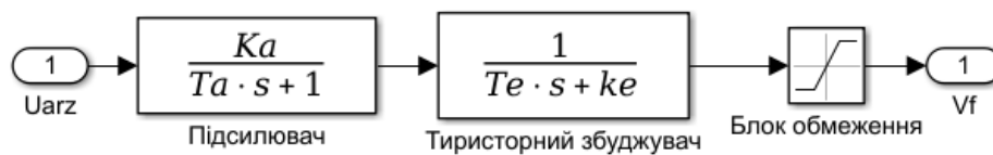
Рисунок 4 – Структурна схема збудника в Matlab
