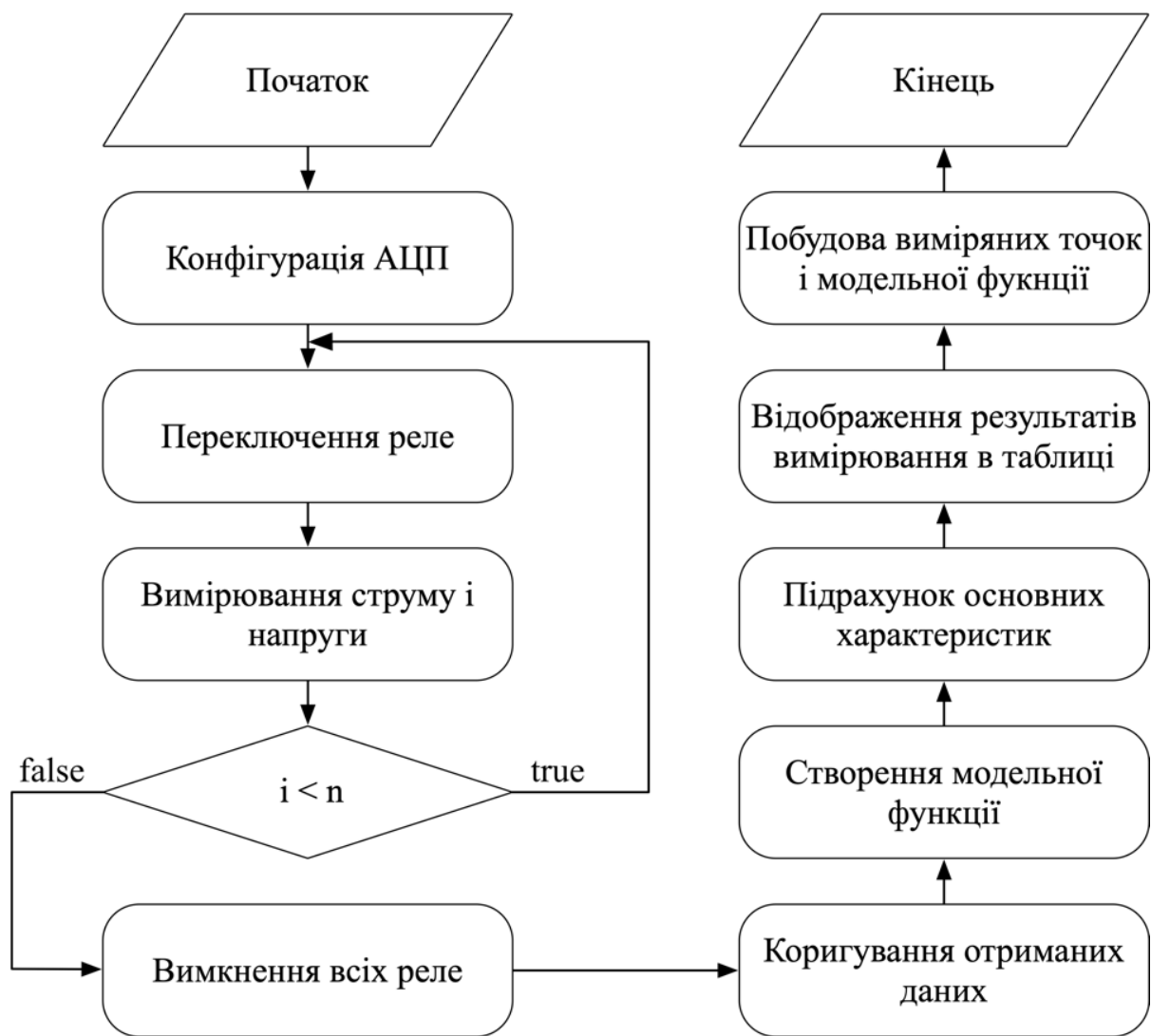
Рисунок 2 – Алгоритм програми з управління процесами вимірювання і обробки даних
