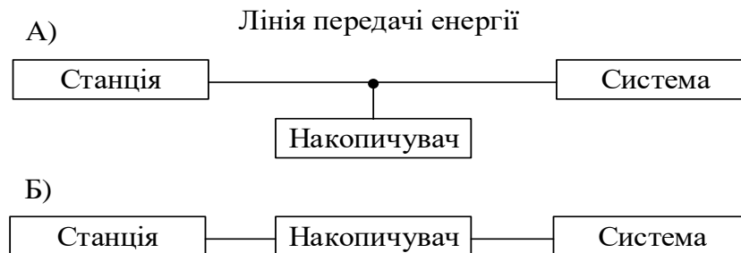
Рисунок 2 – Схема підключення накопичувача електричної енергії
