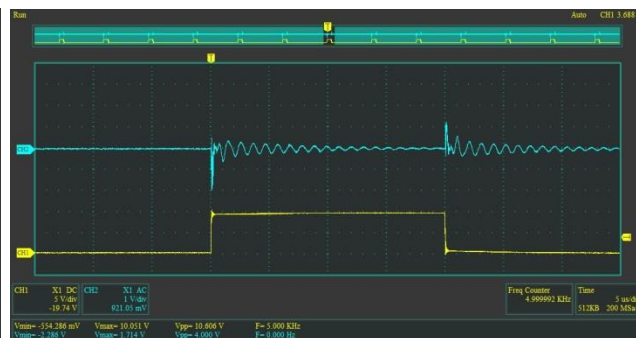
Рисунок 4 – Результат реєстрації калібрувального імпульса вимірювальною схемою
