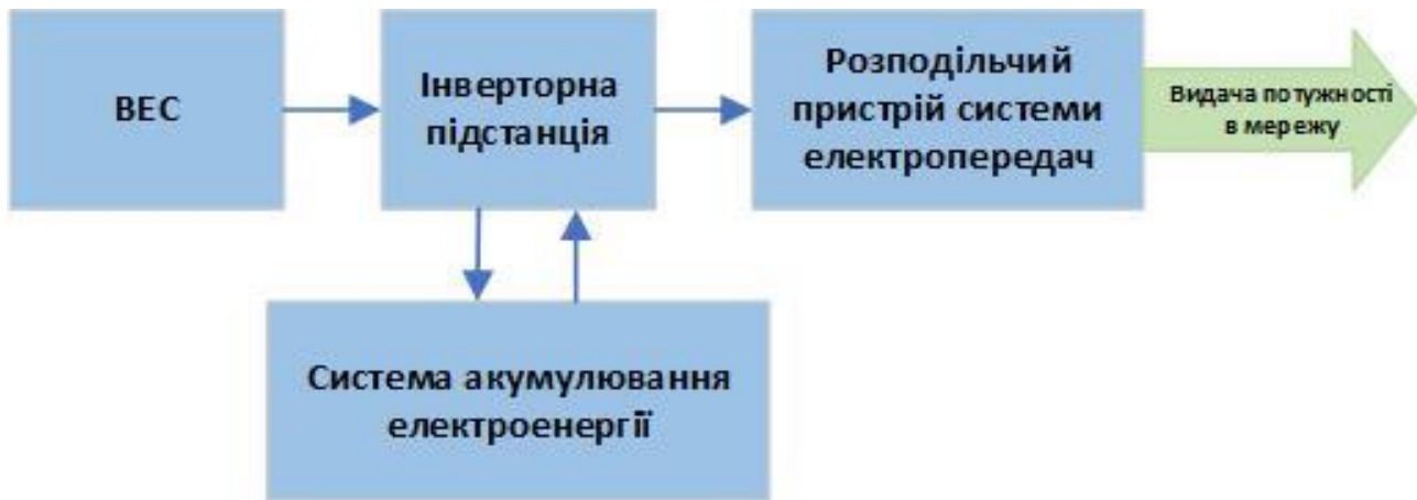
Рисунок 1 – Схема видачі потужності в мережу
