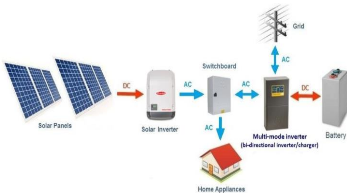
Рисунок 3 – Схема роботи гібридної СЕС
