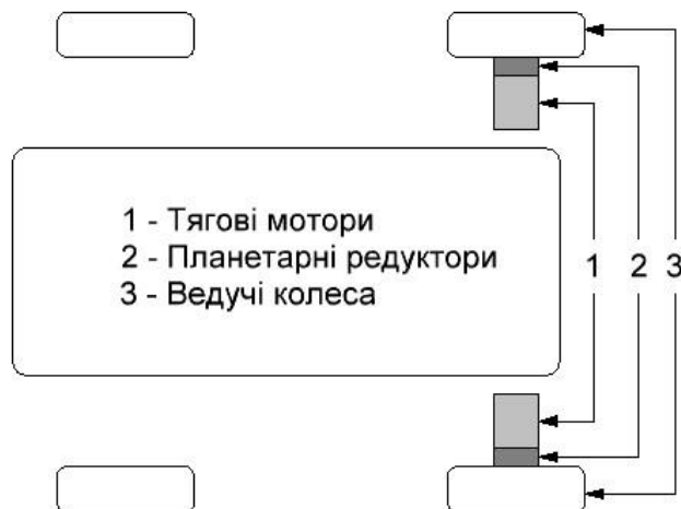
Рисунок 3 – Механічна система електроавтомобіля із індивідуальним приводом коліс
