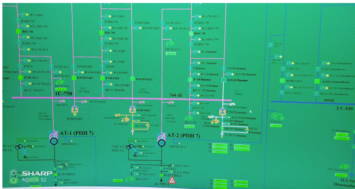
Рисунок 2 – Візуалізація схеми з’єднань ПС-750 кВ “Київська” засобами АСУ ТП
