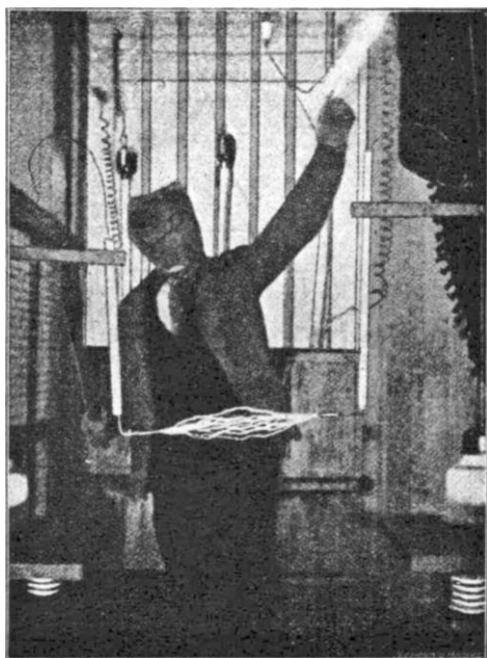
Рисунок 2 – Іскріння між захисним костюмом Артем'єва М.А. і трансформатором
