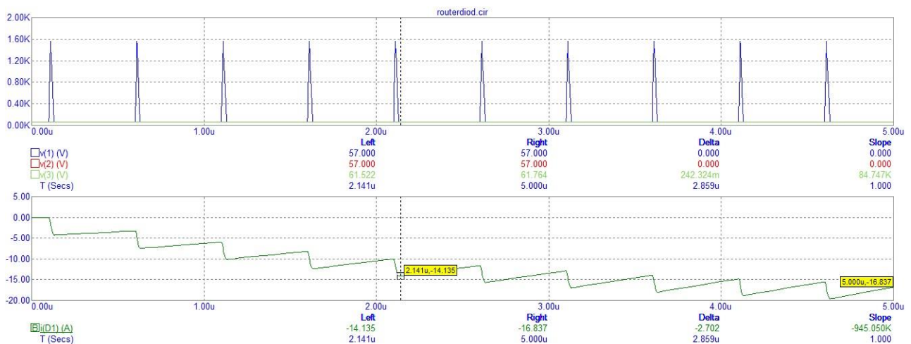
Рисунок 7 – Результати для схеми на рис.5 із захисним діодом ZHCS2000: V1 – напруга на імпульсному джерелі; V2 – напруга на джерелі постійної напруги; V3 – напруга на об’єкті; I(D1) – струм через діод
