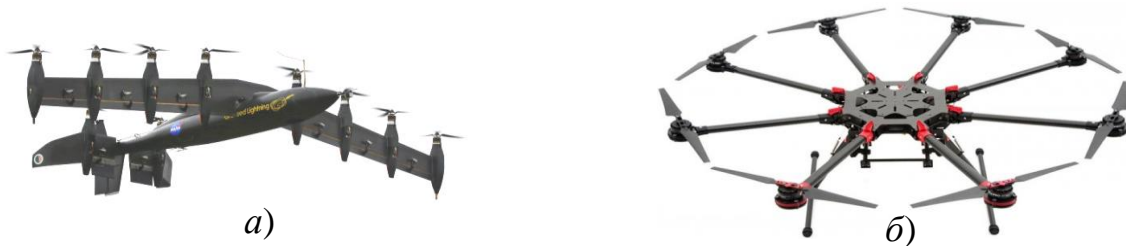
Рисунок 6 – Ізмерні просторові композиції ( k_r = 8 ) тягових електродвигунів в сучасних безпілотних літальних апаратах: а) поперечно-лінійна композиція для гібридного безпілотника (проект NASA) [6]; б) осесиметрична композиція для вантажопідйомного дрона DJI S1000 [7].
