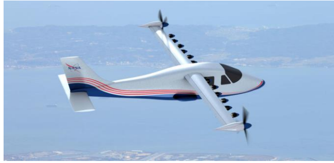
Рисунок 7 – Ізомерна композиція поперечно-лінійного типу в модульній структурі ( k_R = 12 + 2 ) тягових електродвигунів експериментального зразка електролітака NAS-X-57 «Максвелл»
