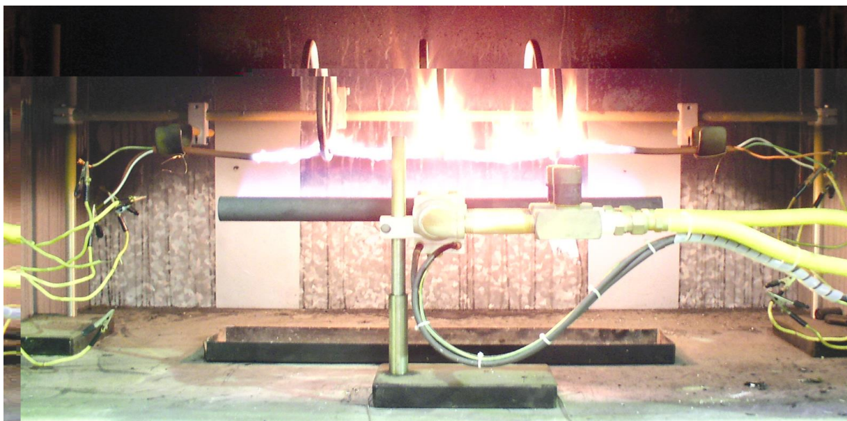
Рисунок 2 – Приклад випробувань силових кабелів на пожежостійкість
