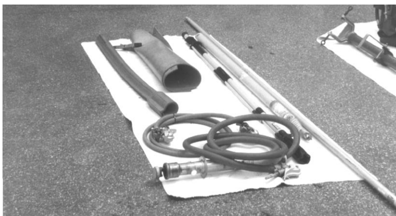
Рисунок 1 – Деякі види ізолювальних пристосувань для робіт під напругою
