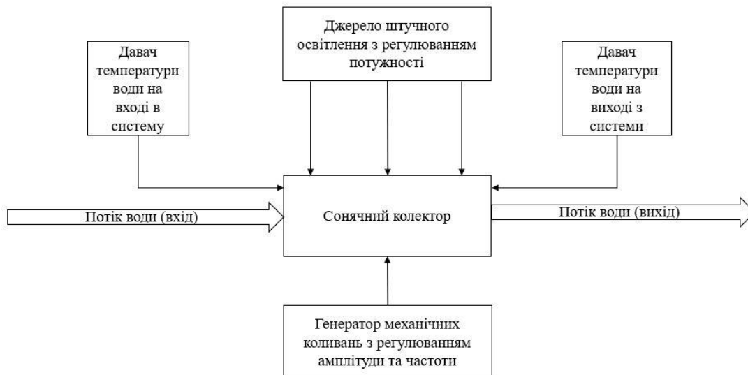
Рисунок 1 – Блок-схема стенду для дослідження інтенсивності нагрівання води у геліоколекторі з вільним режимом теплообміну
