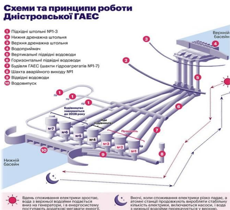
Рисунок 1 – Схема та принцип роботи Дністровської ГАЕС
