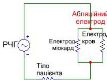
Рисунок 1 – Електротехнічна схема РЧА тканини міокарду
