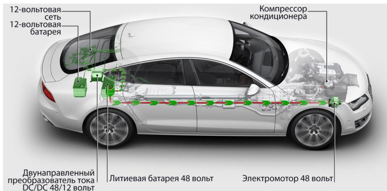
Рисунок 2 – Схема мережі автомобіля з двома акумуляторами
